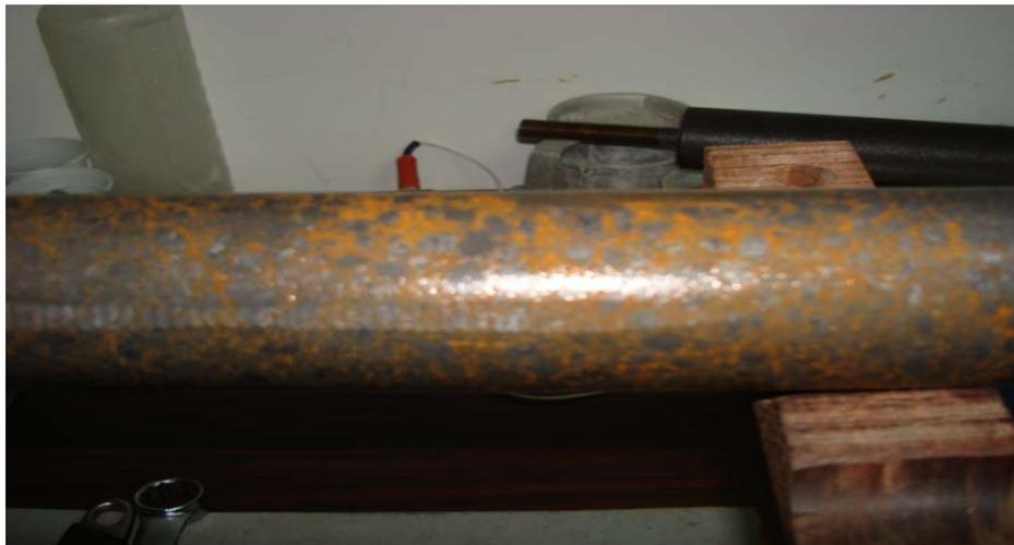
Figura 3.20. Cambio de coloración en la parte superficial del electrodo de grafito.
