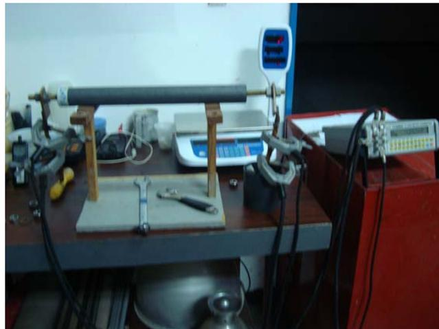
Figura 3.6. Montaje para la prueba de la resistencia longitudinal.
