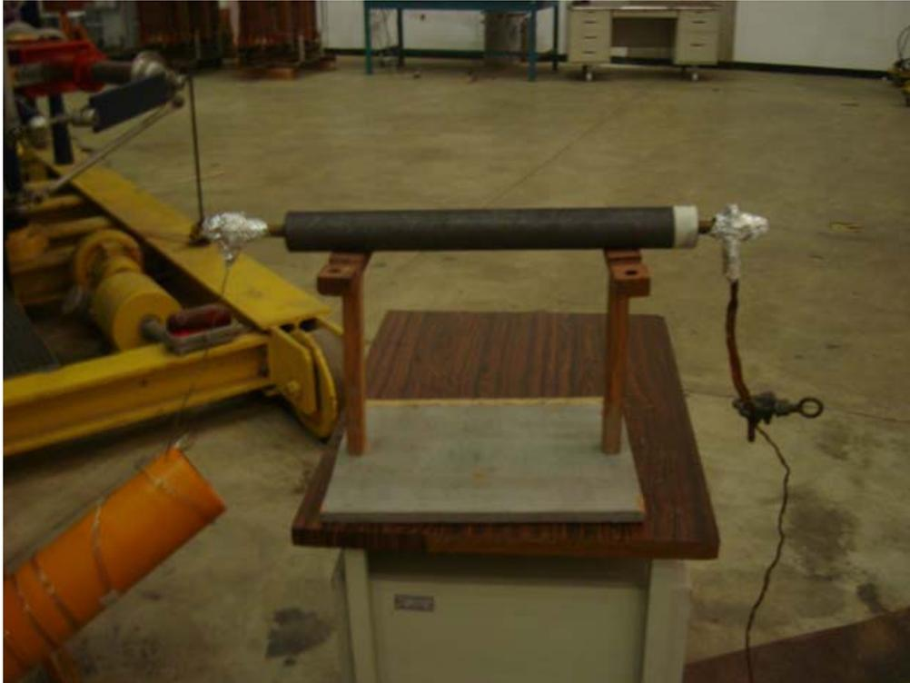
Figura. 3.11. Esquema del montaje del electrodo para la prueba de corriente de impulso tipo rayo.
