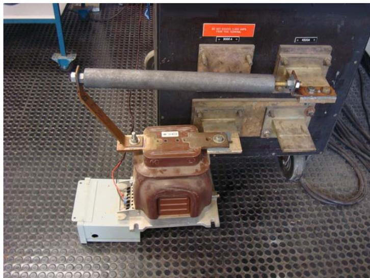
Figura. 3.9. Detalle del conexionado del electrodo a la fuente y al transformador de corriente.
