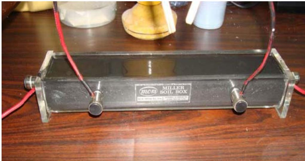
Figura 3.23. Caja de Miller empleada para la medición de la resistencia del material acondicionador.
