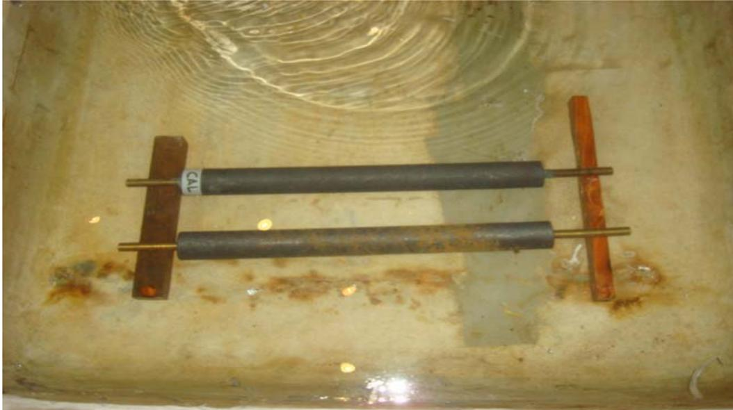
Figura 3.18 Electrodo de grafito introducido en un tanque de agua por 48 h
