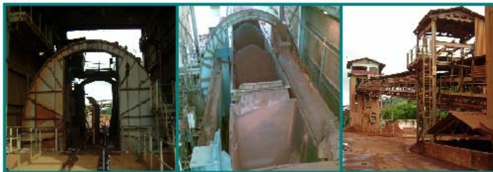
**Figura 2.8. Volcadora de Vagones (lado izquierdo). Vagón desprendido del ferrocarril en la volcadora de vagones (centro). Sistema de cintas transportadoras (lado derecho). [El autor].**
