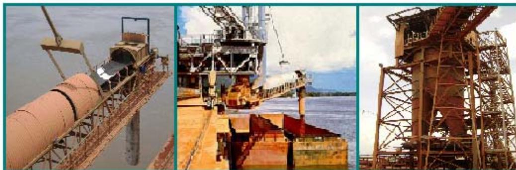
**Figura 2.9. Cargador Mecánico de gabarras (lado izquierdo). Gabarras atracadas en el muelle siendo cargadas (centro). Sistema de bandas transportadoras (lado derecho). [El autor].**
