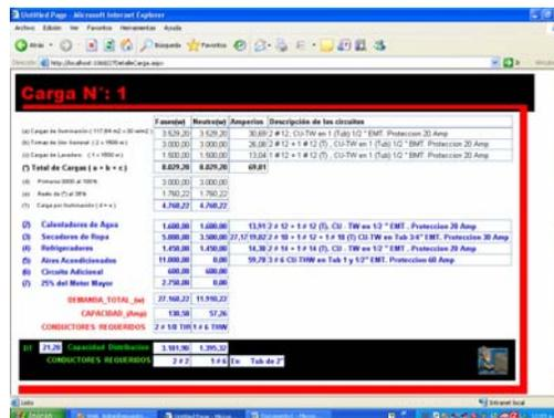
Figura 5.1. Pantalla de Estudio de Cargas, Calibre de Conductores, Calibre de Tuberías y Protecciones
