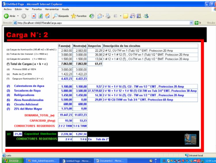
Figura 5.2. Pantalla de Estudio de Cargas, Calibre de Conductores, Calibre de Tuberías y Protecciones del Apartamento 85,4576 m<sup>2</sup>.
