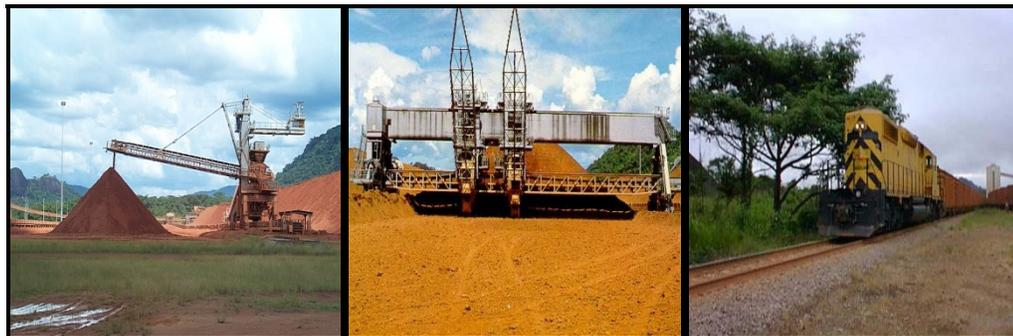
**Figura 1.8** Equipo Apilador Pie de Cerro (lado izquierdo), Recuperación del mineral (centro), Transporte del mineral desde el área Pie de Cerro hasta El Jobal (lado derecho) [El autor]
