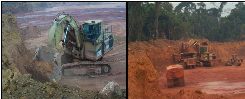
**Figura 1.4** Pala hidráulica con carga de material bauxítico (lado izquierdo)
