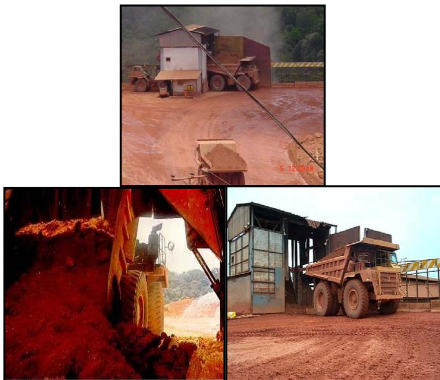
**Figura 1.5** Molino de Trituración (arriba) Camión roquero en maniobra de descarga en la tolva de la estación trituración (abajo, izquierda), descarga de camiones en el triturador (abajo derecho) [El autor]
