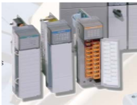
Figura 3.33: Módulos de entradas y salidas. [9]
