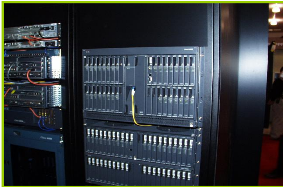
Figura 1.5. Multiplexor de acceso DSL (DSLAM) [5]
