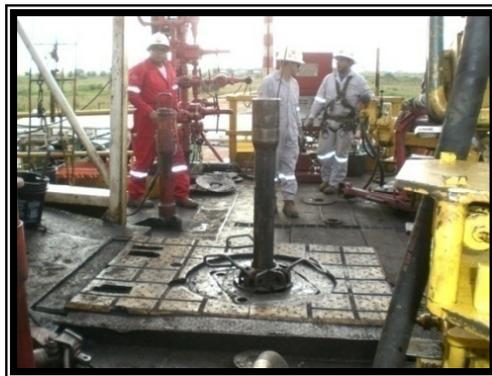
Figura 3.3 Planchada y mesa rotaria del taladro Ptx-1500
