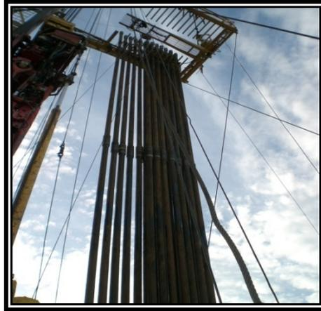
Figura 3.4 Encuelladero y tubería de perforación del taladro Ptx-1500
