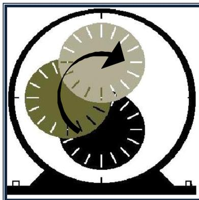
**Figura 3.19.** Posición del rotor ante excentricidad dinámica.
