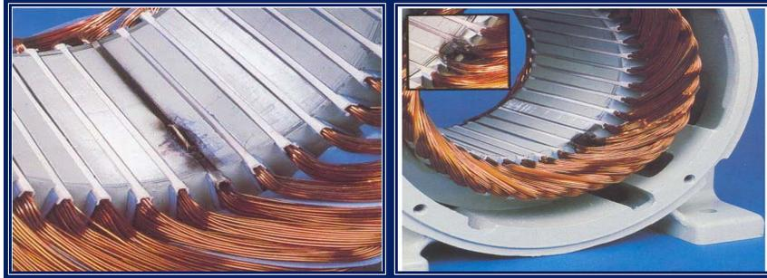
**Figura 2.12.** Falla a Tierra en el Borde De una Ranura.
