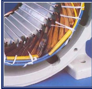
**Figura 2.9.**Falla de un Devanado por una Sobretensión.
