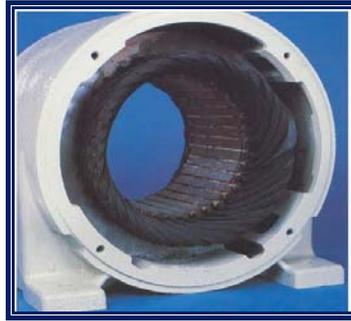
**Figura 2.8.** Devanado dañado por una sobrecarga.
