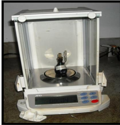
**Figura 3.5. Reflejo de la Muestra de Crudo Pesada Una Vez Alcanzada la Temperatura de 100 y 130 ° F**
