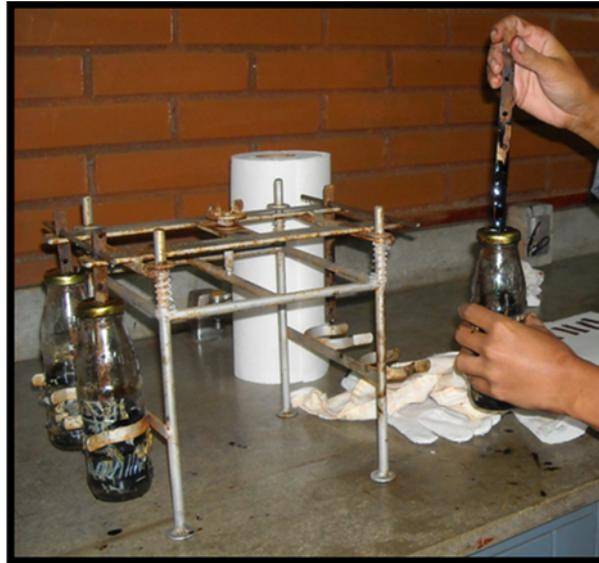
**Figura 3.22. Observación de la Coloración de la Lámina de Cobre Una Vez Terminada la Prueba de Corrosión al Cobre**
