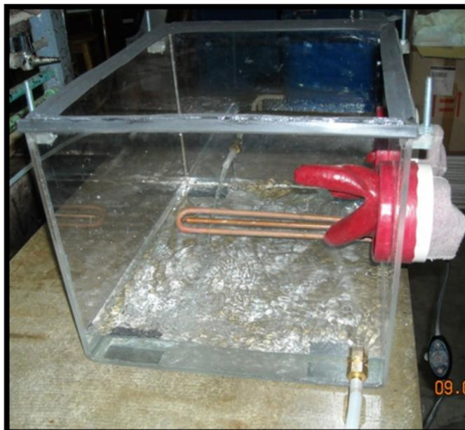
**Figura 3.13. Equipo Fabricado para la Prueba de Corrosión al Cobre sin las Botellas donde se Introducirán las Muestras de Crudo**
