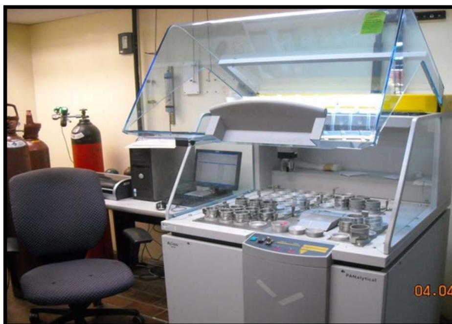
**Figura 2.3**Equipo de Espectrometría de Fluorescencia de Rayos X para la Detección de Azufre (Fuente: Refinería de P.L.C.)
