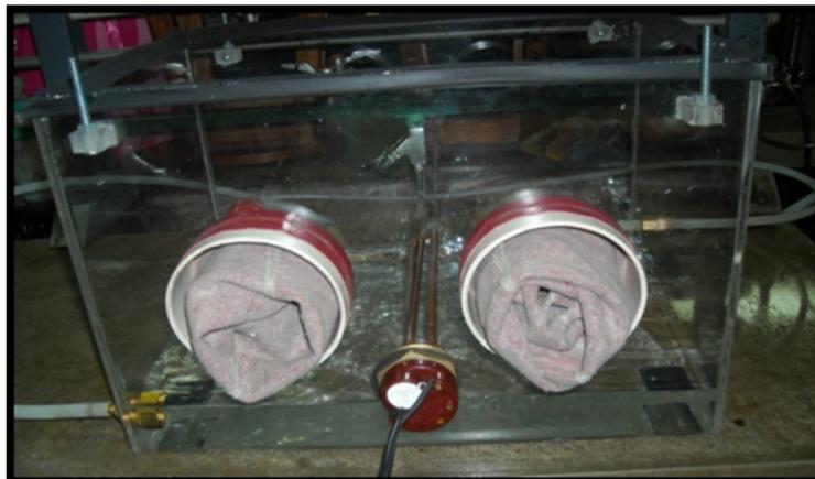
**Figura 3.16. Equipo con la resistencia que se utilizó para alcanzar la temperatura de trabajo**
