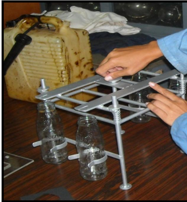
**Figura 3.17. Soporte Metálico para Sujetar las Muestras de Crudo en el Momento de la Prueba**
