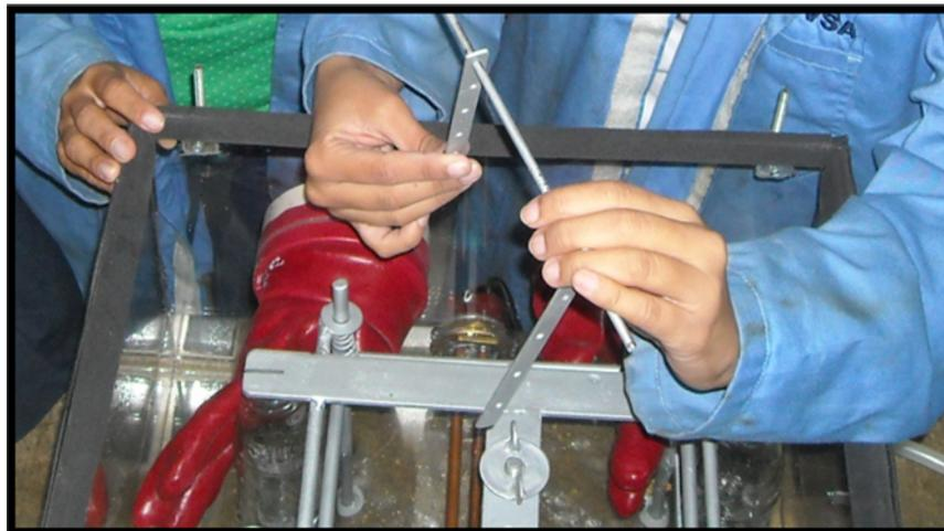
**Figura 3.18. Platinas de Hierro Donde Serán Colocadas las Láminas que Estarán Suspendidas en el Crudo Antes de Alcanzar la Temperatura Deseada**
