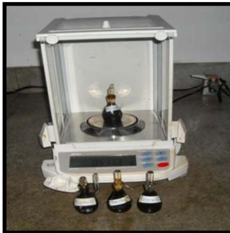
**Figura 3.4. Peso de las Muestras Listas en el Picnómetro a Temperatura Ambiente**
