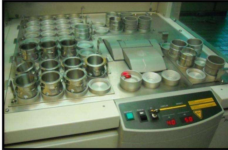
**Figura 3.9. Equipo en Funcionamiento para Determinar el Porcentaje de Azufre de Una de las Muestras**
