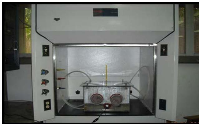
**Figura 3.20. Momento de la Prueba de Corrosión al Cobre con las Láminas Sumergidas en cada Una de las Muestras**
