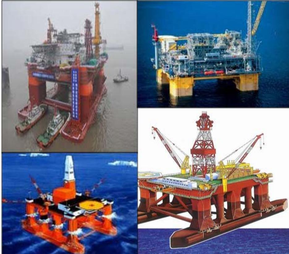
**Figura 2.12** Plataforma Semisumergible
