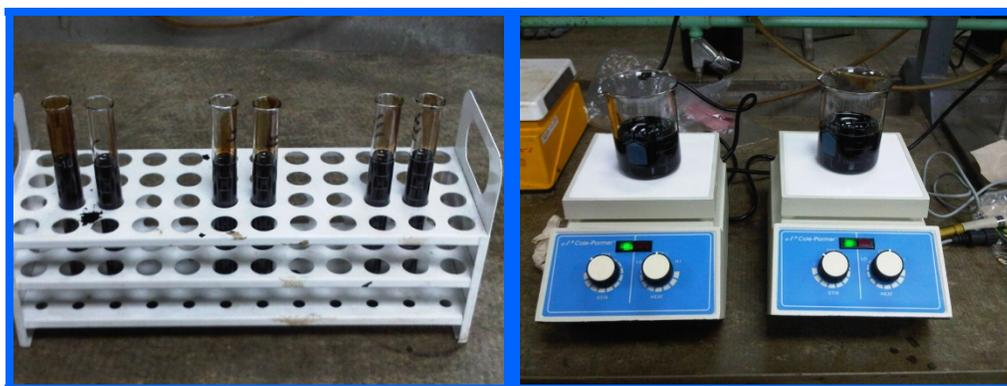
Figura 3.6.- Equipo para la realización de las pruebas de coalescencia.
