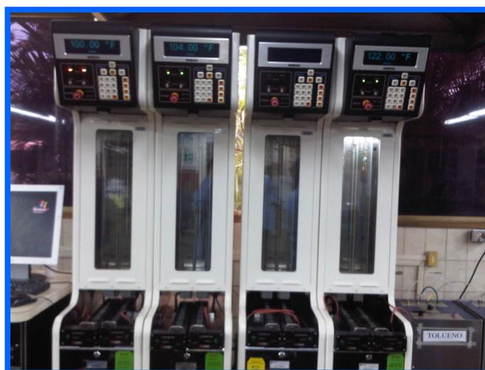
Figura 3.5.- Equipo para la medición de la viscosidad cinemática del crudo Mesa.
