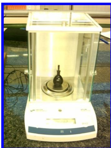
Figura 3.3.- Equipo para la medición de la densidad del crudo Mesa.
