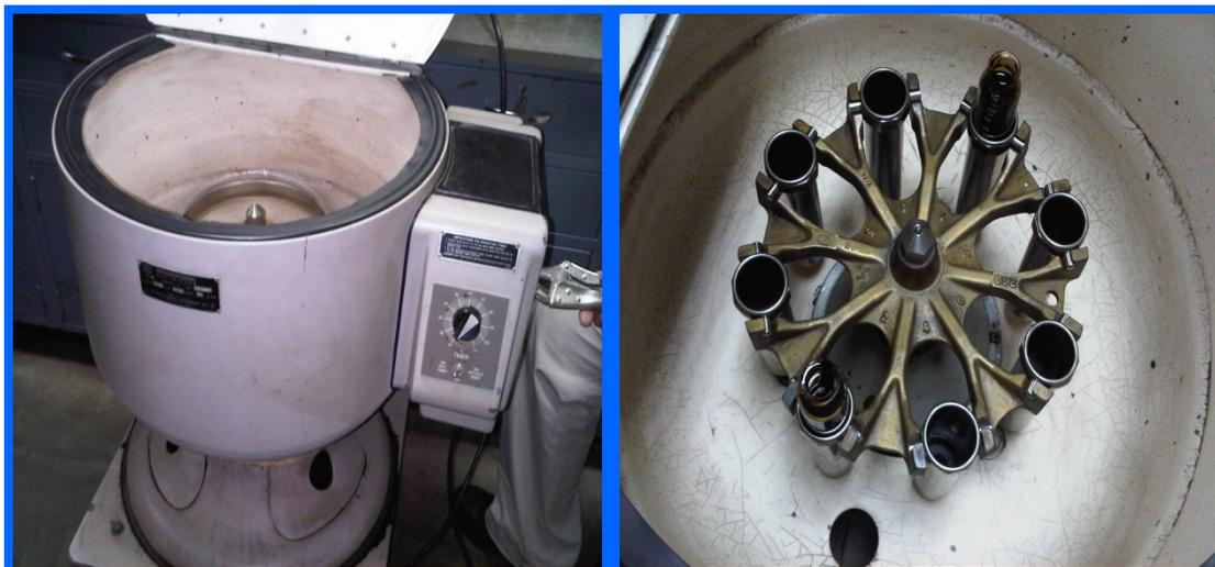
Figura 3.1.- Equipo para la determinación del porcentaje de agua y sedimentos.
