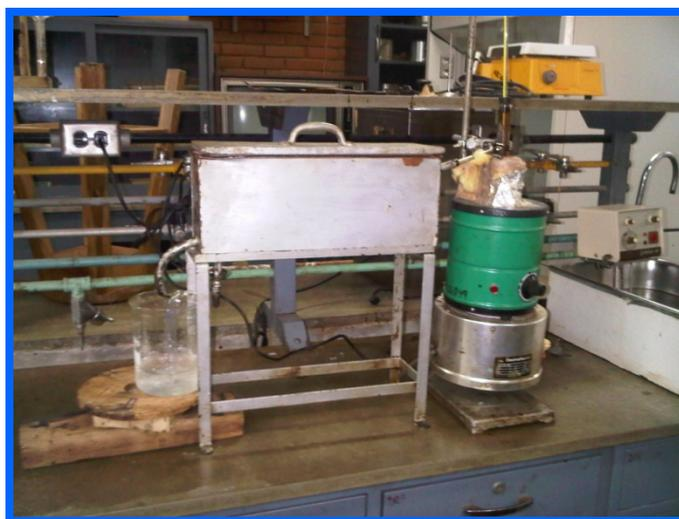
Figura 3.4.- Equipo para la medición de la destilación del crudo Mesa.
