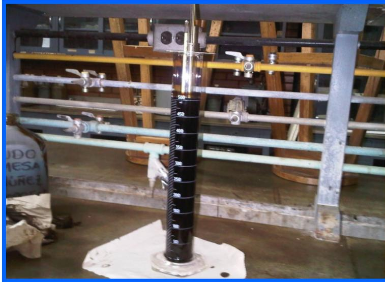
Figura 3.2.- Equipo para la medición de la gravedad API del crudo Mesa.
