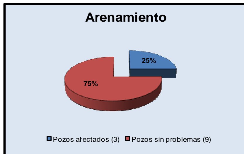
Figura 4.12.: Pozos Afectados por Arenamiento.
