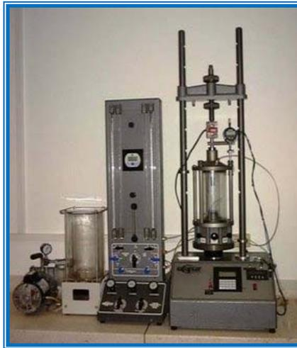
**Figura N° 2.6 Ensayo de compresión triaxial <sup>[4]</sup>**
