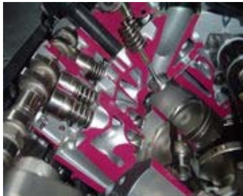
Figura 2.11 Válvulas y árbol de levas
