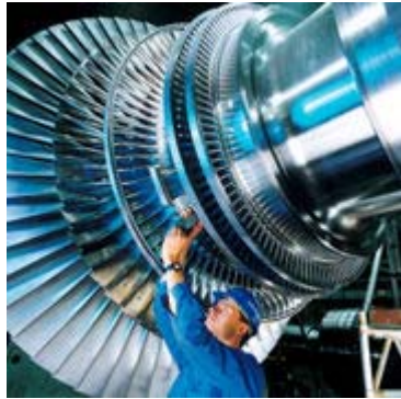
Figura 2.13 Rotor de una turbina de vapor producida por Siemens
