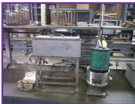
*Figura 3.4. Equipo de destilación atmosférica. Método ASTM D-86.*
