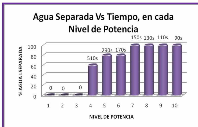
**Figura 4.17.** Agua liberada en cada nivel de potencia para el crudo 1 al 5%, mostrando el tiempo al cual se alcanzaron las temperaturas
