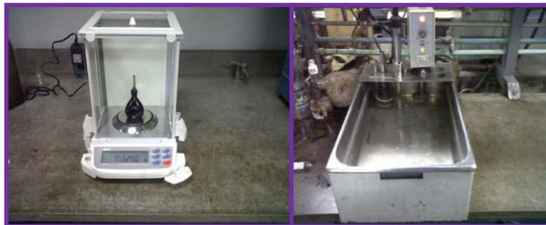
*Figura 3.3. Equipos utilizados para medir las densidades de los crudos*
