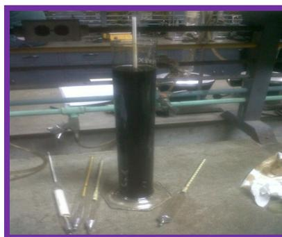
**Figura 3.2. Medición de la gravedad API. Método ASTM D 287**
