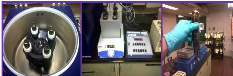
*Figura 3.1. Procedimiento para determinar el porcentaje de agua y sedimentos.*
