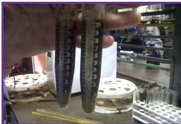
**Figura 4.18. Lectura de la cantidad de agua separada, de la muestra de crudo 1 al 10%, después de ser sometida al proceso de deshidratación**
