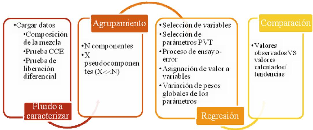
**Figura 3.4. Diagrama esquemático de las etapas requeridas para el ajuste de la EDE del fluido del yacimiento.**
