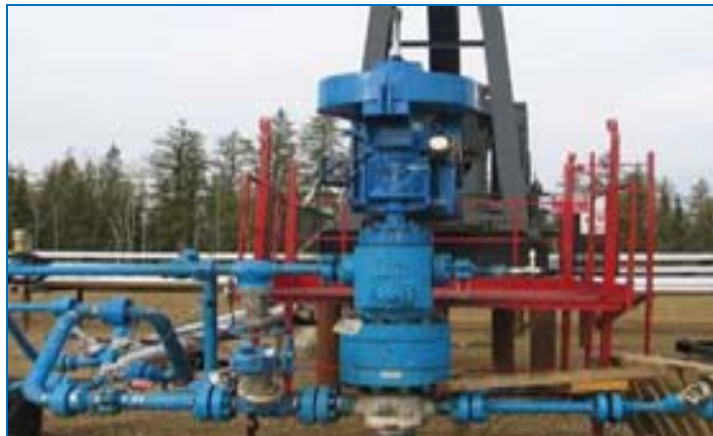
Figura 2.22. Cabezal para alta temperatura, Canadá.
