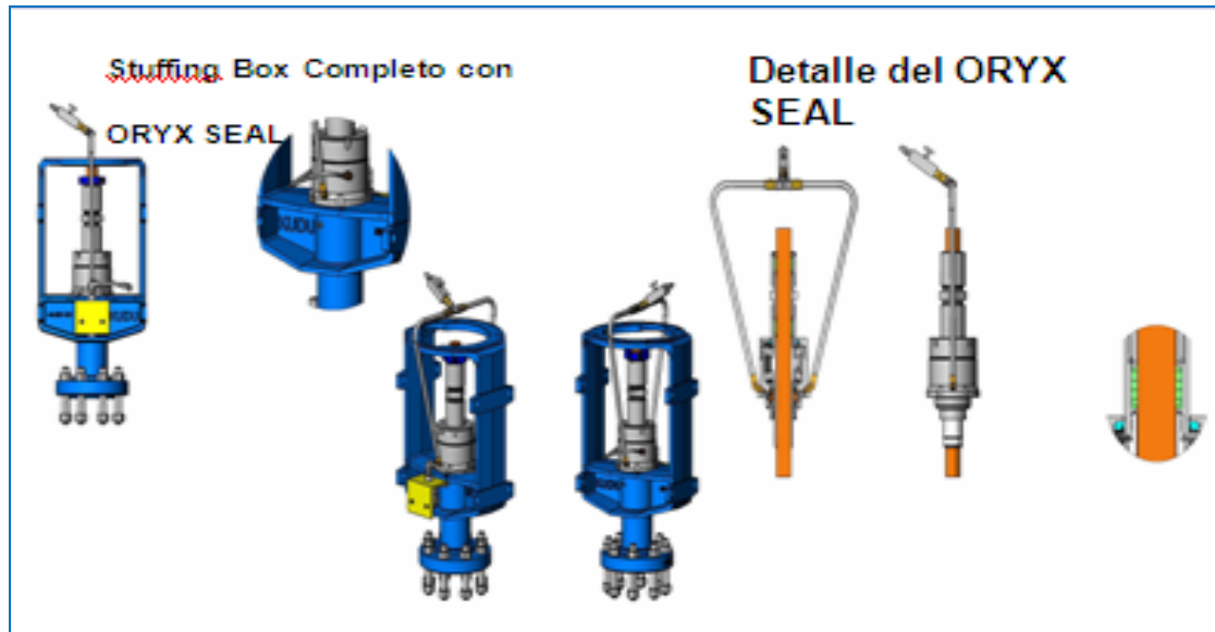
Figura 2.23. Detalles del cabezal para alta temperatura (330°C) Sello Metal-Metal.
