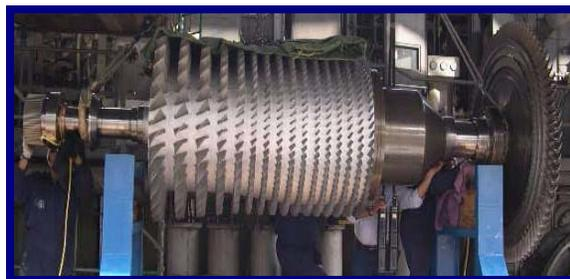
**Figura 2.4 Modelo de un compresor axial**
