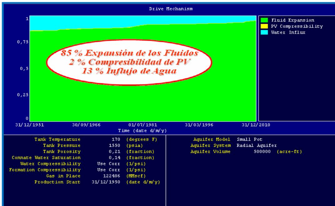
**Figura 4.16. Mecanismos de producción generado por MBal para el Yacimiento JM-15 NAE1,2**
