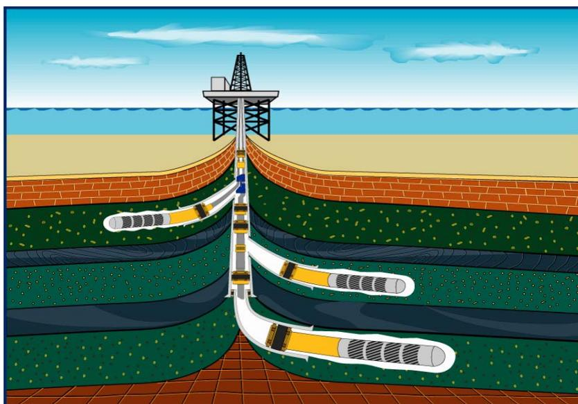
**Figura 2.22 Perforación Multilateral** <sup>[14]</sup>
