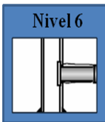
Figura 2.19. Nivel 6 de la clasificación de pozos multilaterales según sus juntas. [11]
