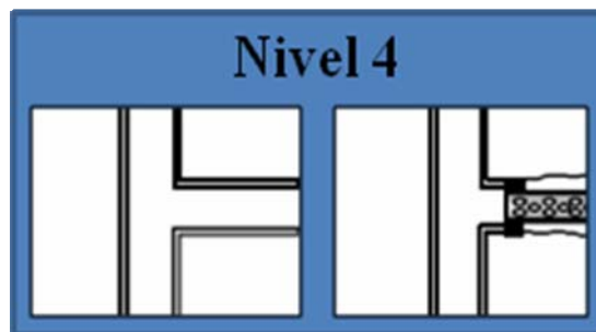
Figura 2.17. Nivel 4 de la clasificación de pozos multilaterales según sus juntas. [11]
