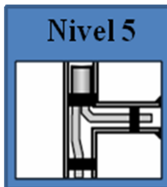
Figura 2.18. Nivel 5 de la clasificación de pozos multilaterales según sus juntas. [11]
