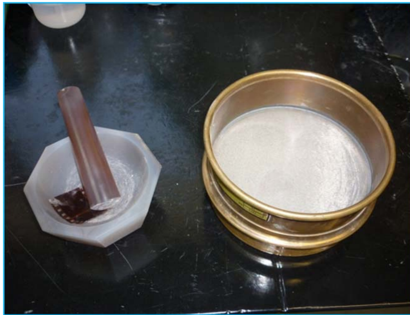
Fig. 20: Mortero de porcelana y tamiz.
