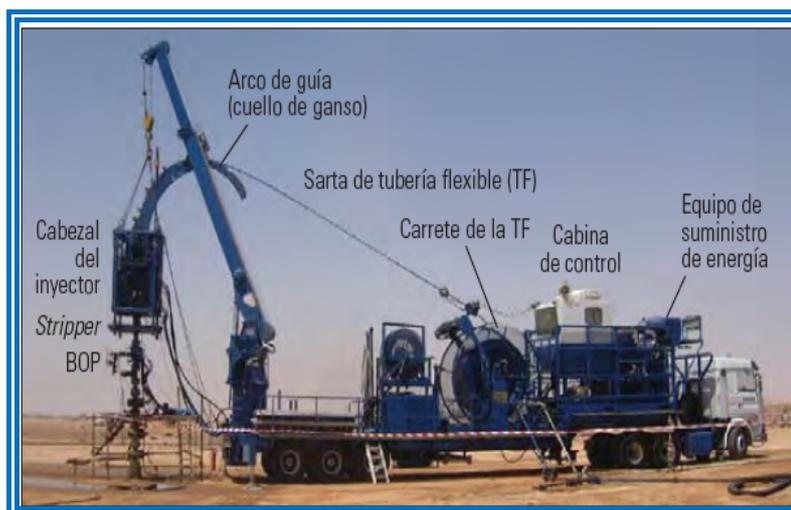
**Fig. N° 2.8: Unidad de Tubería Flexible.** <sup>[13]</sup>
