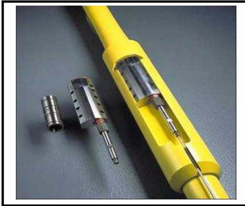
**Figura 2.11. Sensores de fondo.** <sup>[5]</sup>
