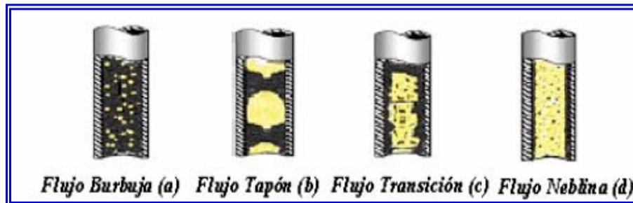
Fig. N° 3.14 Patrones de Flujo en Tuberías Verticales. [6]
