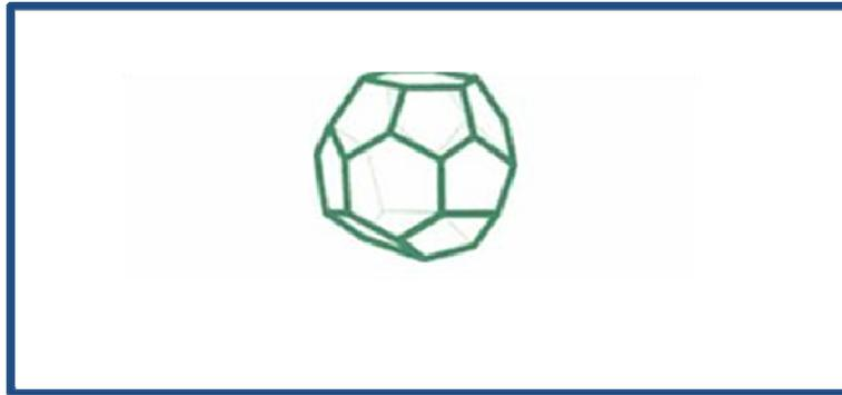
**Figura 22 Cavity Grande de la Estructura II Formada por 12 Pentágonos y 4 Hexágonos.**
