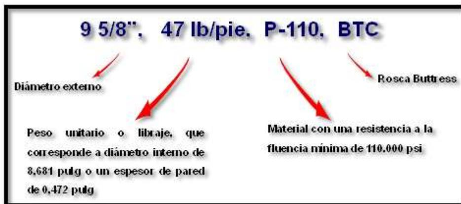
**Figura 2.3 Especificaciones de la tubería de revestimiento**
