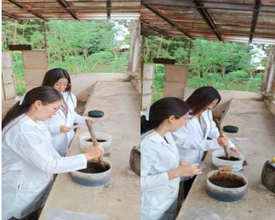
**Figura A.2 Contaminación de las muestras de suelo**
