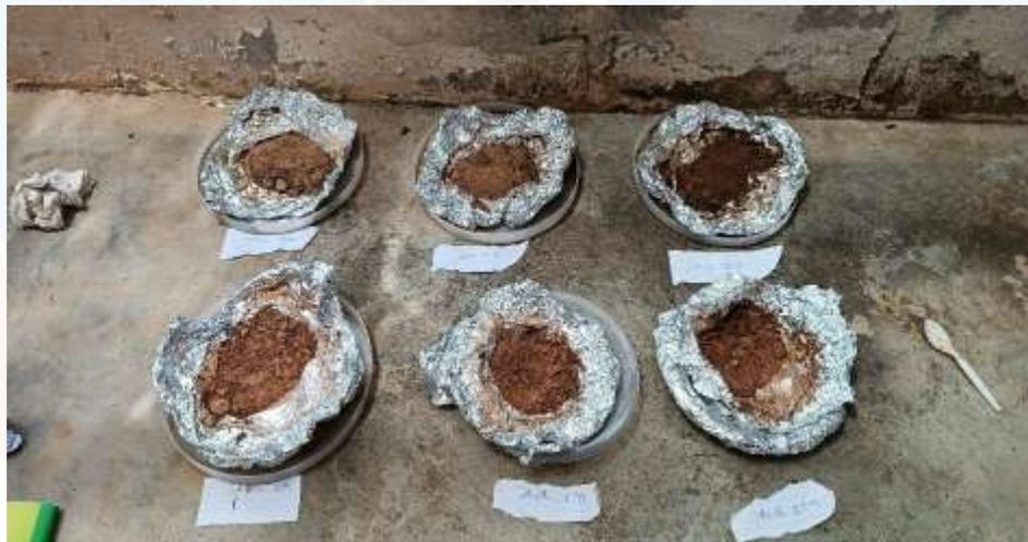
**Figura A.7 Muestras de suelo luego del proceso delavado**
