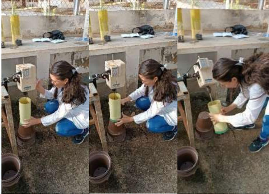
**Figura A.6 Lavado de suelo con tanque agitado**
