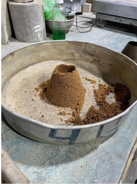
Figura 3.13. verificación de humedad en S.S.S
