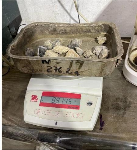
Figura 3.32. Muestra del agregado grueso seco, antes de ser lavado.
