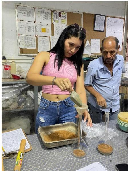
Figura 3.14. Colocación del material dentro del picnómetro.
