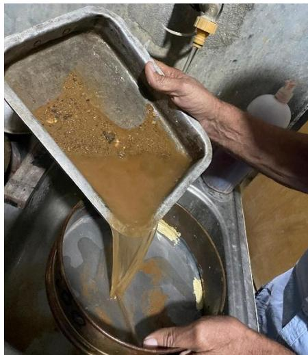
Figura 3.33. Lavado del agregado fino en el tamiz número 200.
