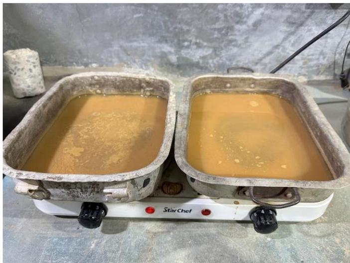
Figura 3.19. Secado de la arena para la absorción.
