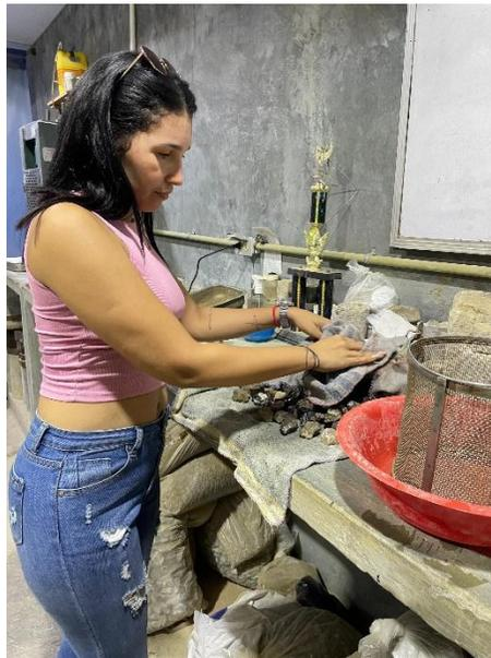
Figura 3.20. Secado del agregado grueso para conseguir la humedad S.S.S.
