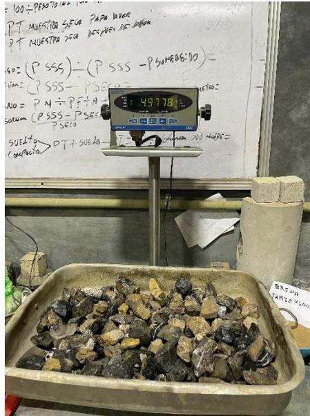
Figura 3.21. Pesado del agregado grueso en S.S.S en el aire.
