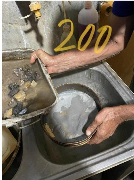
Figura 3.34. Lavado del agregado grueso en el tamiz 200.
