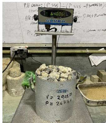
Figura 3.24. Peso de la muestra para P.U.S
