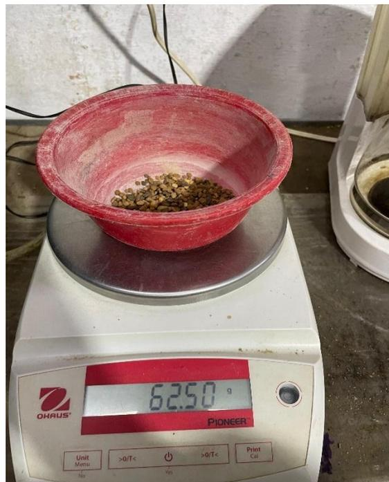
Figura 3.8. Pesado del agregado fino.
