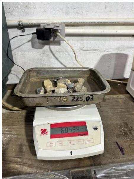
Figura 3.28. peso del agregado grueso en estado natural.
