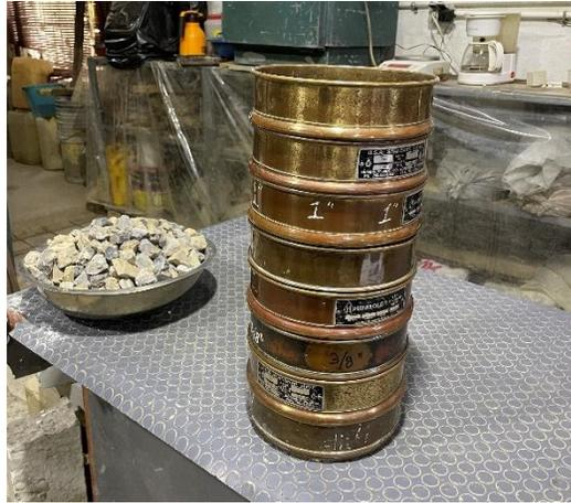
Figura 3.9. Cedazo para el agregado grueso.
