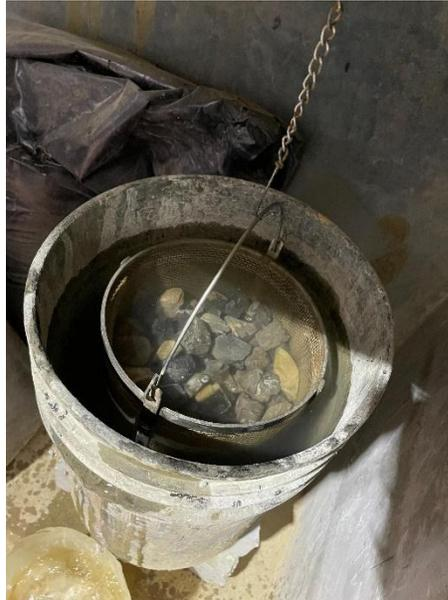
Figura 3.22. Peso de la muestra sumergida en agua.
