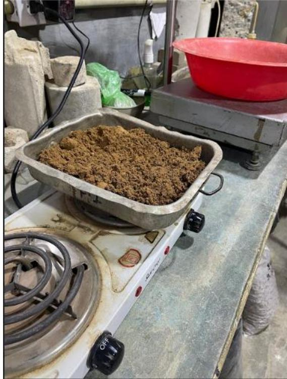
Figura 3.12. Secado de la muestra en cocina eléctrica, para conseguir la condición S.S.S.
