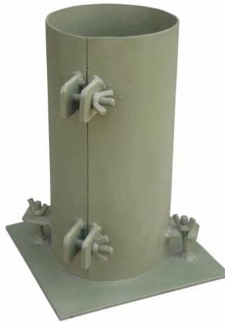
Figura 1.2. Moldes metálicos para concreto.
