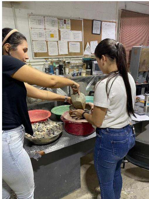
Figura 3.6. Tamizado del agregado grueso.
