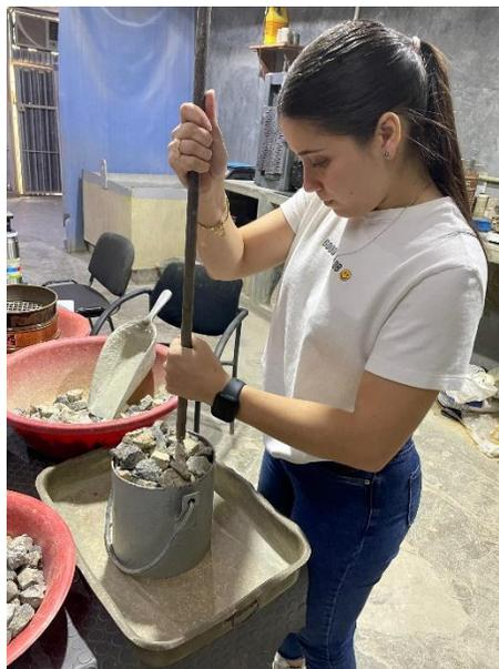
Figura 3.26. Compactación de las capas del agregado grueso.
