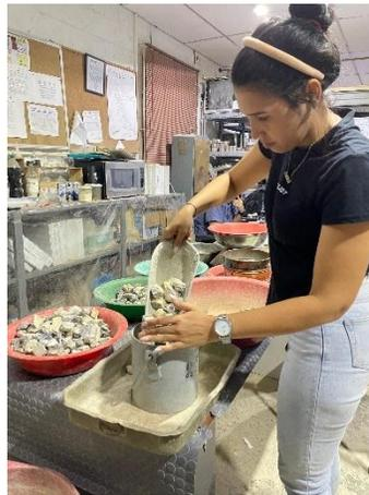
Figura 3.23. Colocación del agregado grueso en el cilindro.
