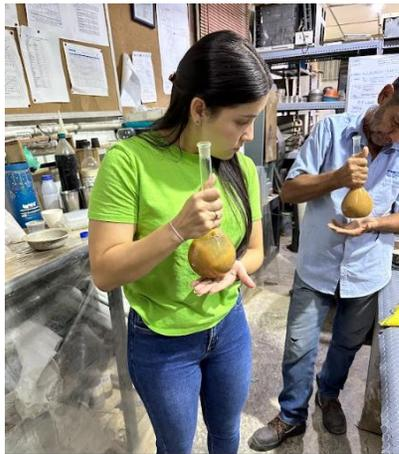
Figura 3.17. Agitación de la muestra y el agua dentro del picnómetro.
