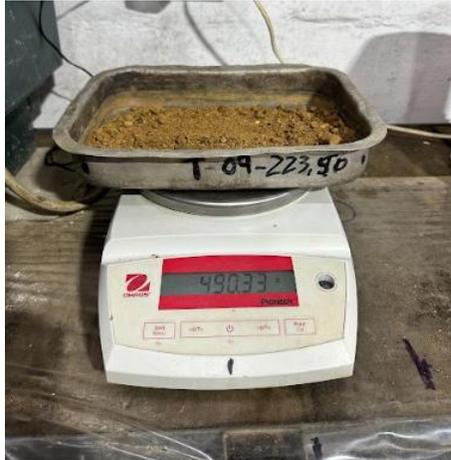
Figura 3.29. Peso del agregado fino seco.
