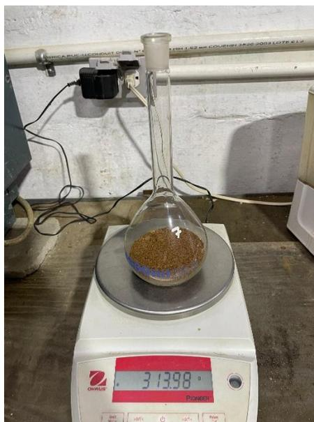
Figura 3.15. Muestra pesada en el picnómetro.
