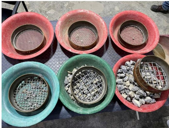
Figura 3.10. Granulometría del agregado grueso
