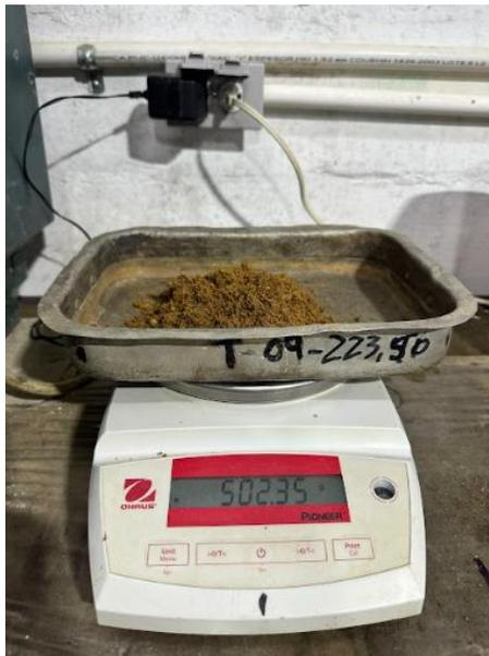
Figura 3.27. peso del agregado fino en estado natural.
