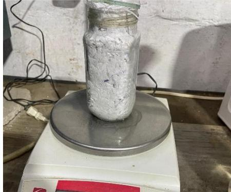
Figura 3.35. Pesado de la fibra de saco de polipropileno más el envase.
