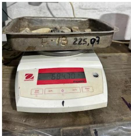
Figura 3.30. Peso del agregado grueso seco.
