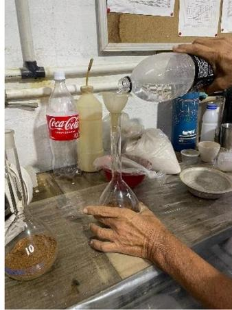
Figura 3.16. Colocación de agua a la muestra dentro del picnómetro.
