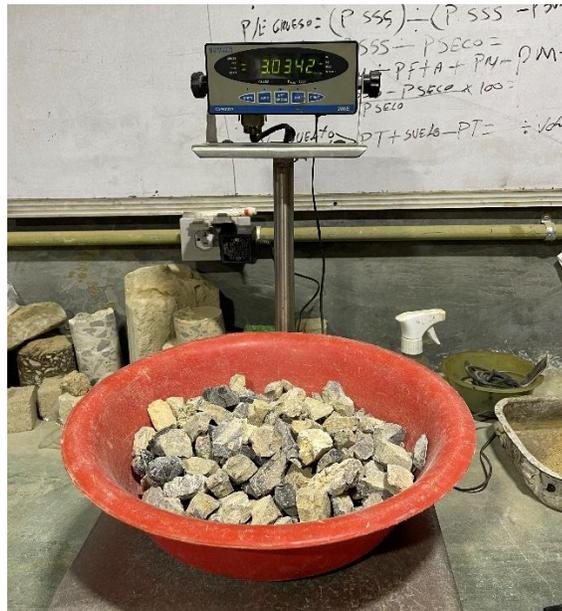
Figura 3.7. Pesado del agregado grueso.
