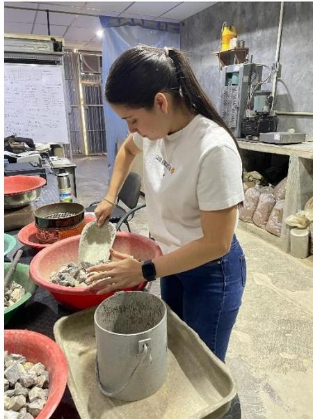
Figura 3.25. Colocación del material por capa.
