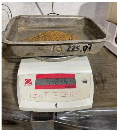
Figura 3.31. Agregado fino seco, antes de ser lavado.
