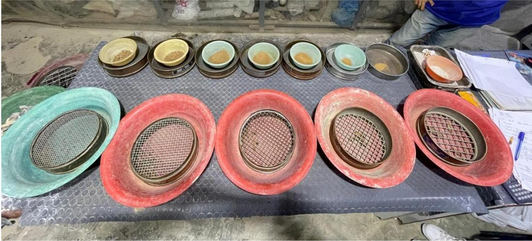
Figura 3.11. Granulometría del agregado fino.
