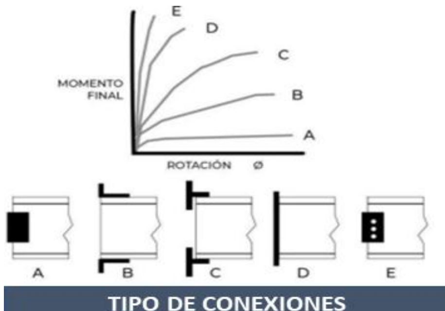
Figura N° 89 Tipos de conexiones en perfiles de acero.
