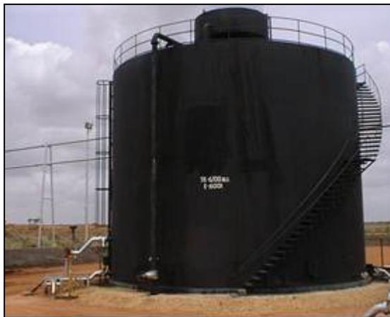
**Figura 2.6.** Tanque de Lavado
