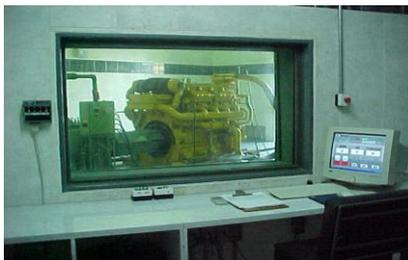
**Figura 11. Cabina de prueba del Dinamómetro**
