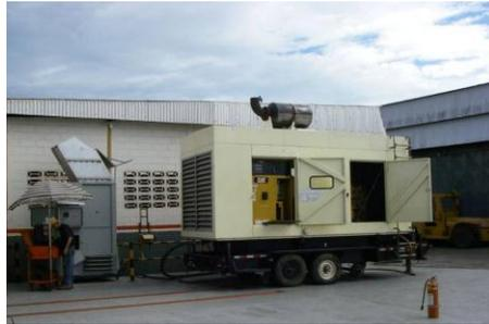
**Figura 9. Banco de carga resistivo (prueba eléctrica)**
