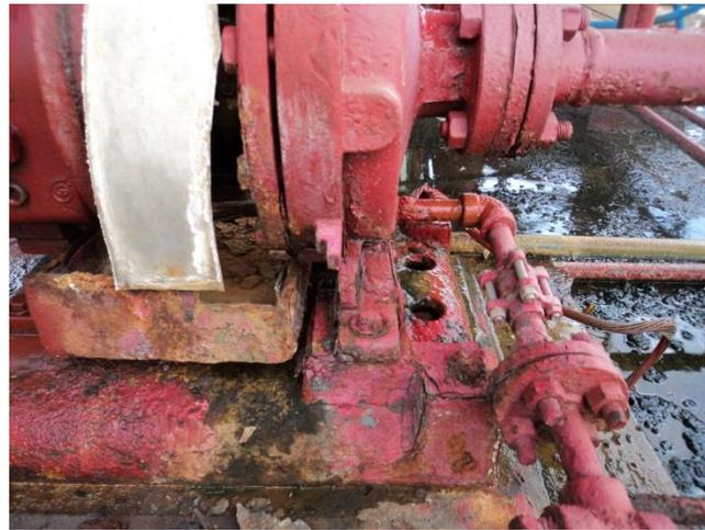
**Figura 4.14. Corrosión debido al agua salubre**
