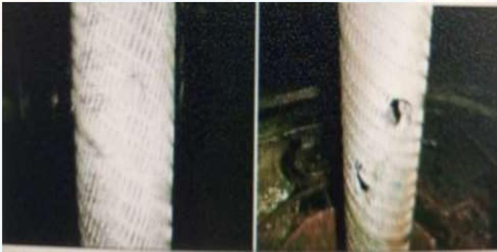
**Figura 2.8 Erosión causada por la producción de arena**
