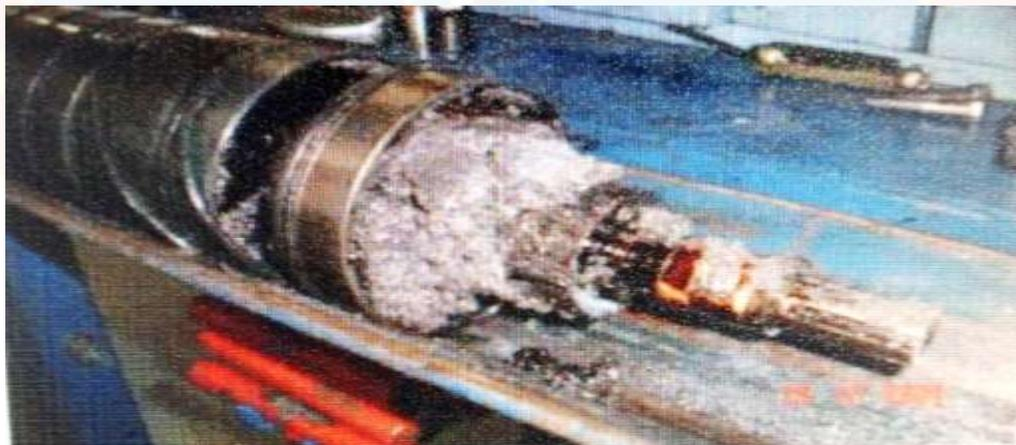
**Figura 2.7 Acumulación de arena en los equipos.**
