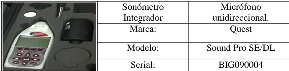
**Figura 3.3. Instrumento medición de ruido sonómetro.**
