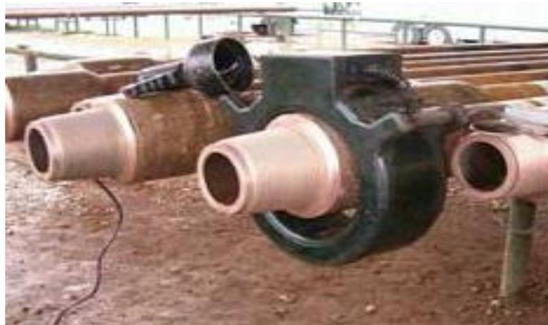
**Figura 4.4. Medición de diámetro Externo.**
