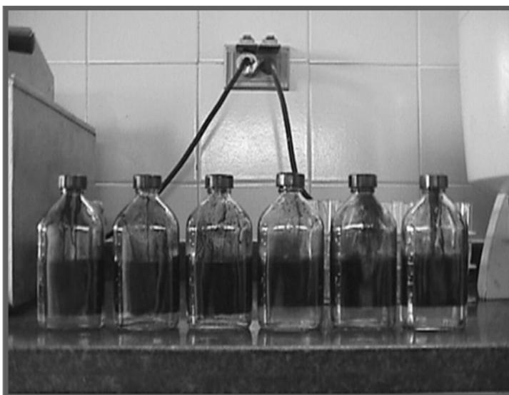
**Figura 3.12** Agua separada mediante el método de prueba de botella.
