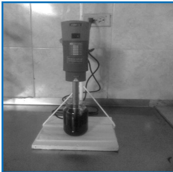
**Figura 3.7 Preparación de la emulsión en el laboratorio.**
