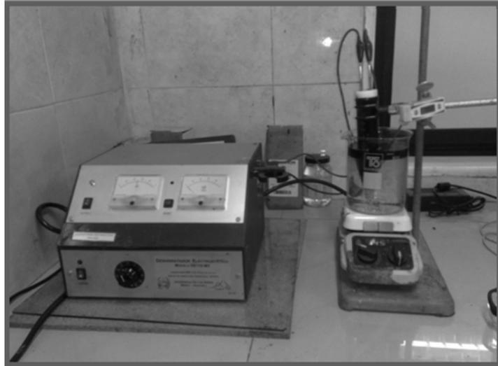
**Figura.3.13 Rompimiento de la emulsión con el deshidratador electrostático.**
