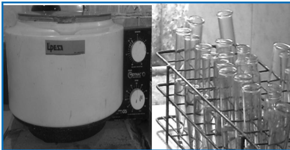
**Figura 3.1 Centrifuga y tubos para la determinación del %AyS.**
