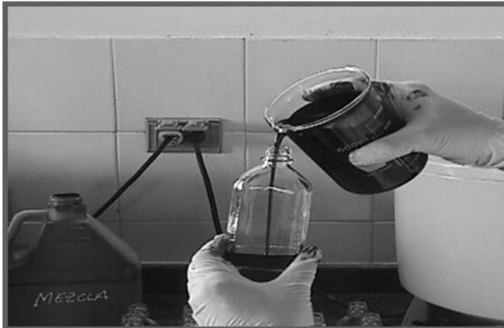
**Figura 3.8 Adición de la emulsión agua-crudo en la botella de 100 ml.**
