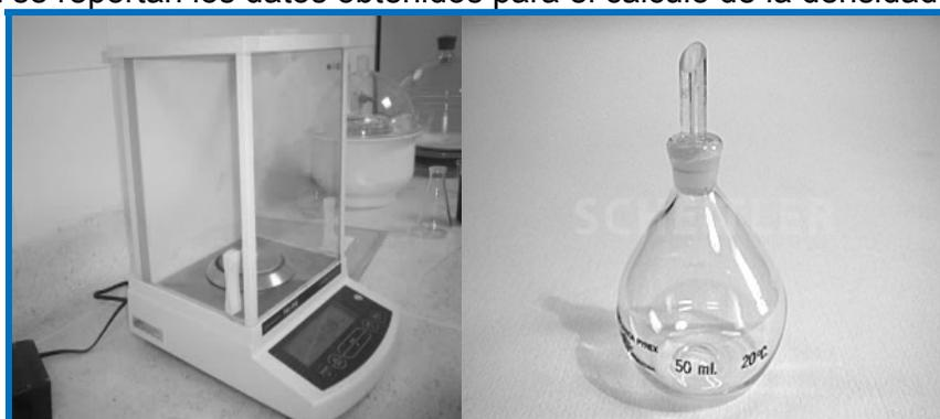
Figura 3.4 Balanza analítica y picnómetro para la medición de la densidad.
