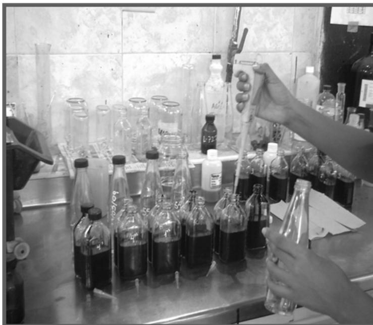
**Figura 3.9 Dosificación del desemulsionante a diferentes concentraciones.**
