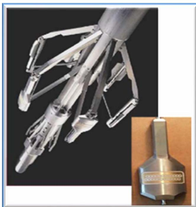
**Figura N° 2.32.** Imagen resistiva "STAR". A la derecha detalle de uno de los patines. <sup>[16]</sup>
