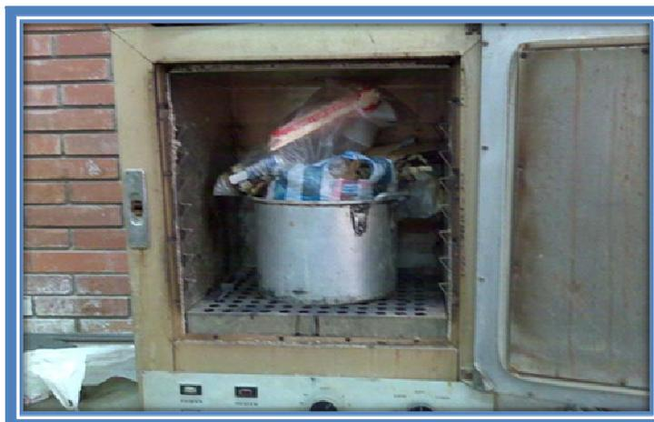
Figura 3.12 Muestra en el horno precalentado a 105°C.
