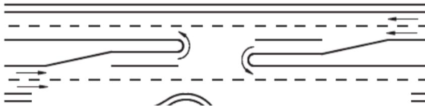
**Figura 4. Apertura típica de separador con carriles de aceleración y desaceleración.**
