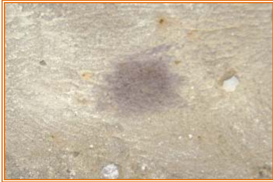
Fig. 5.3 Reacción de la fenoltaleína en la superficie de la columna.
