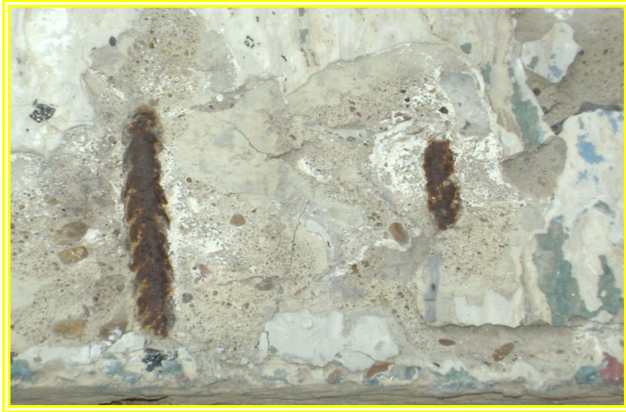
Fig. 5.4 Reacción del nitrato de plata, aplicado alrededor de las cabillas.
