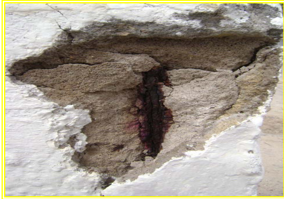
Fig. 5.1 Reacción de la fenoltaleína en la columna.
