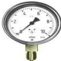
Figura 3.7. Manómetro de Baja Presión
