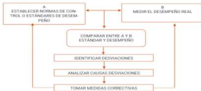
Figura N° 1. Proceso de control. Fuente: De Zuani (2005), pp. 376
