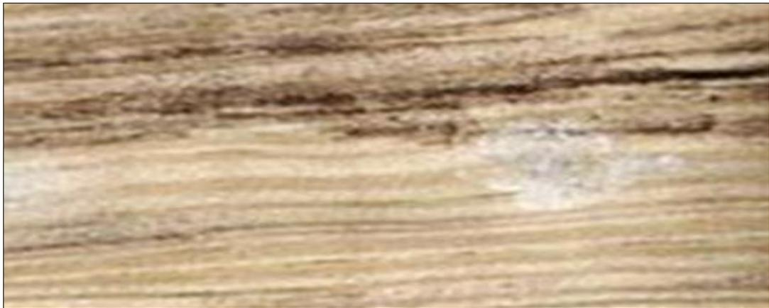
Figura 3.7. Pieza de madera atacada por Moho. (Fritz, 2010)
