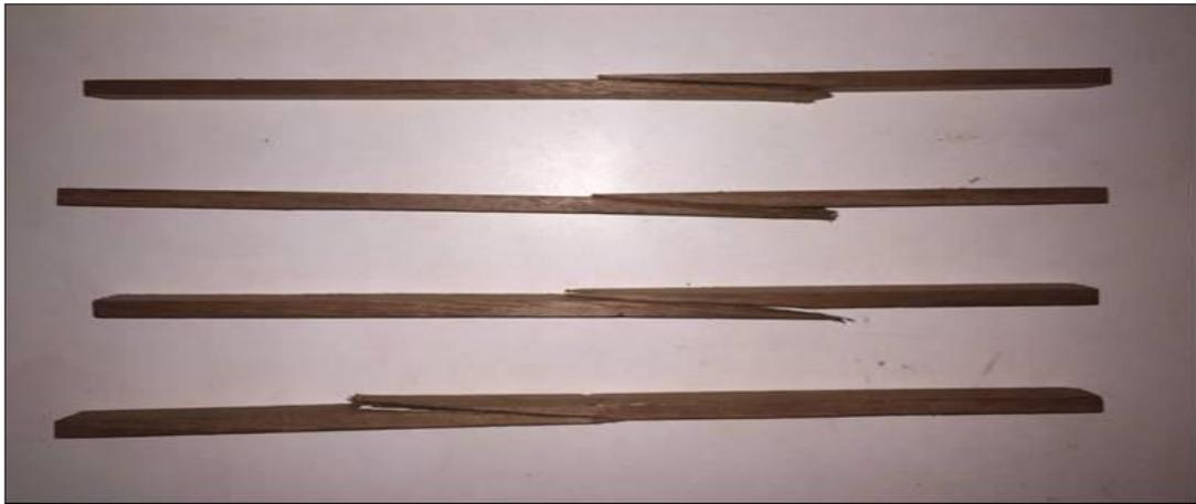
Figura 5.3. Muestras después de alcanzar las cargas de rotura en Moreillo.
