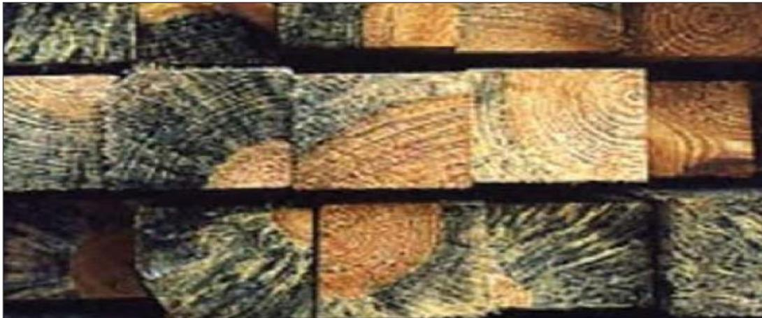
Figura 3.4. Degradación de la madera. (Centro de transferencia tecnológica de la madera, 2007).
