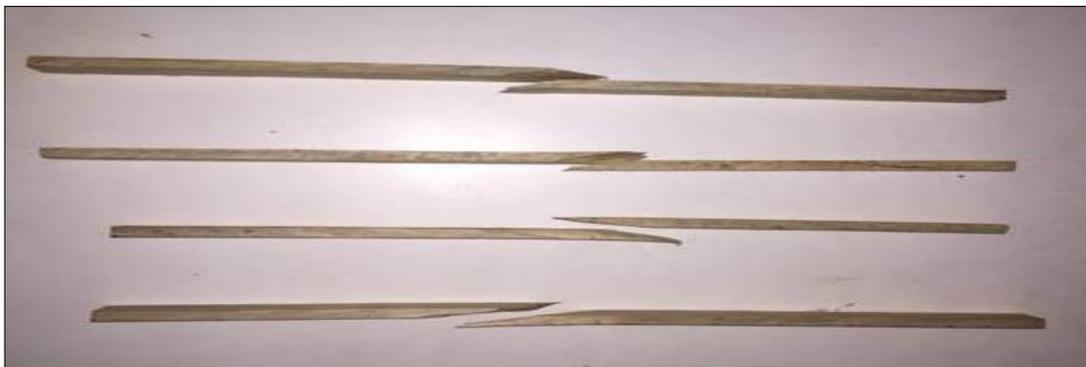
Figura 5.6. Muestras después de alcanzar las cargas de rotura en Pino.
