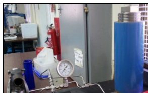
Figura A.5. Enchaquetadota, se utiliza para acoplar la chaqueta a la muestra.
