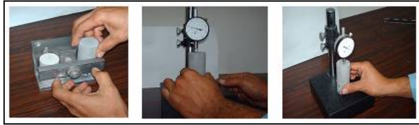
Figura 3.12. Secuencia de pasos para el control de calidad de las probetas. Fuente: LFR, 2006.
