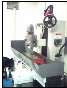
Figura A.2. Pulidora WILTON 52A PSG-68, se utiliza para pulir las caras de la muestra.
