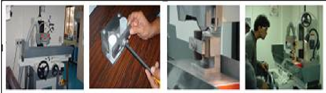
Figura 3.9. Secuencia de pasos para el pulido de las caras de las probetas. Fuente: LFR, 2006.
