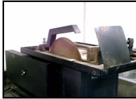
Figura A.1. Cortadora RAYTECH ALP-105, se utiliza para emparejar la muestra.
