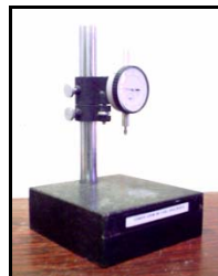
Figura A.3. Extensiómetro MITUTOYO, se utiliza para verificar que las caras estén paralelas, tiene una apreciación de (0 \pm 0.0001'') .
