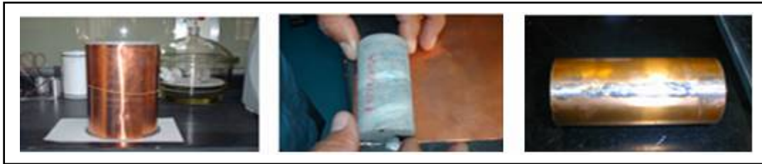
Figura 3.13. Secuencia de pasos para la colocación de la chaqueta de cobre en la probeta. Fuente: LFR, 2006.
