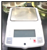
Figura A.4. Balanza Digital OHAUS, se utiliza para medir la masa de la muestra en gramos.
