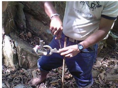
**F.13. Técnico del Ministerio del Ambiente armando el Correntómetro para medición de velocidades.**
