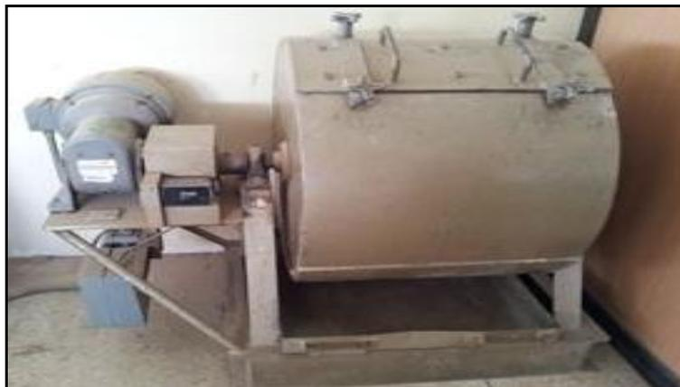
Figura 3.2 Equipo para ensayo de Abrasión (Tipo A)
