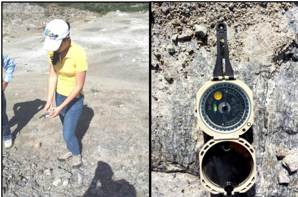
Figura 4.2 Mediciones del rumbo de la foliación en las rocas aflorantes
