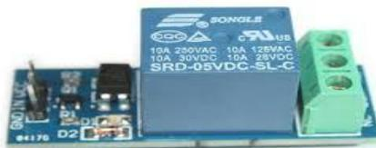
Figura 39. Relé electromagnético 5Vcd.
