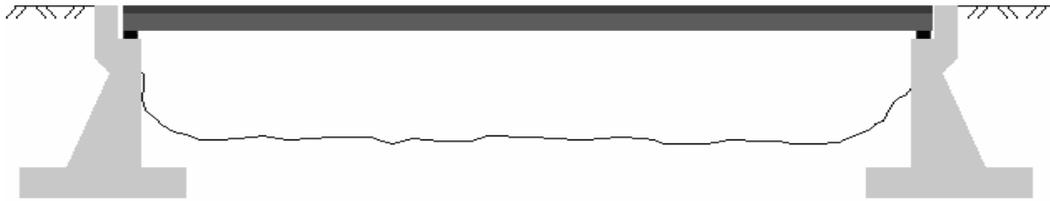
**Figura 2.1 Puente de Vigas Simplemente Apoyadas (Isostáticos)**
