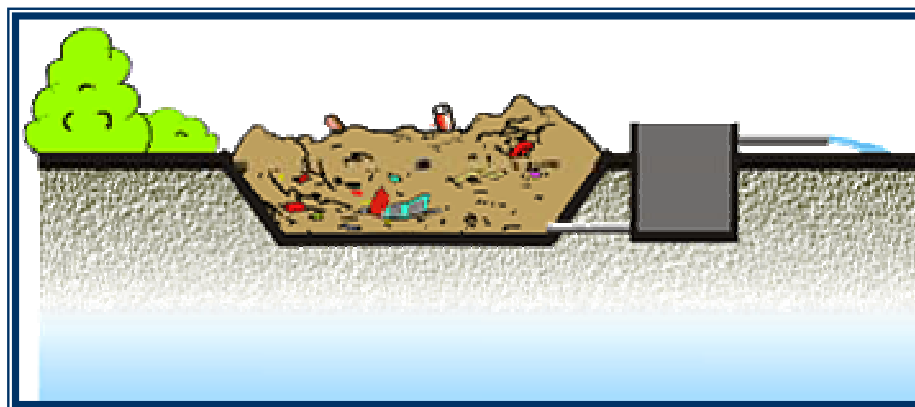
Figura 3.3. Contaminación por Lixiviados de Residuos Sólidos en Vertederos.
